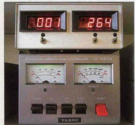
Bild 19: Bei 10-GHz-Antennen ist die Richtungsanzeige am unteren Originalgerät faktisch unbrauchbar. Die winkelgradgenaue Anzeige erfolgt deshalb im oberen Gerät digital. Die normale Antennendrehgeschwindigkeit kann beibehalten oder mit Impulssteuerung verringert werden.
