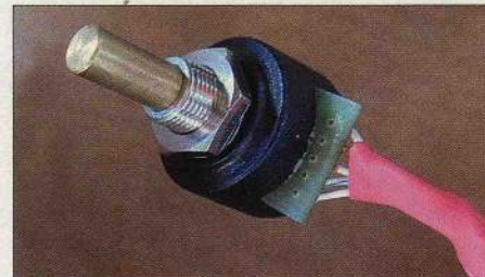
Bild 21: Dieser Encoder dient zur Messwertaufnahme der Drehposition vom Rotor. Mit seiner 6-mm-Achse und der üblichen Zentralbefestigung kann er gegen das in den Rotoren eingebaute 500-Ω-Potentiometer ausgetauscht werden.
