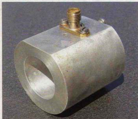
Bild 17: Kommerzieller Hornstrahler für 10 GHz aus Aluminium mit SMA-Koaxialanschluss
